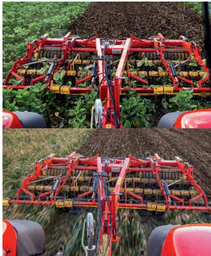
Ножовий коток Crosscutter створює замульчований шар ґрунту зі сприятливими умовами для проростання падалиці та бур'янів
