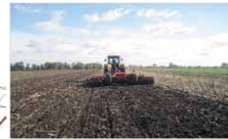
Результат роботи за один прохід по стерні соняшника дискової борони Carrier 625 XL з додатковою опцією Crosscutter
