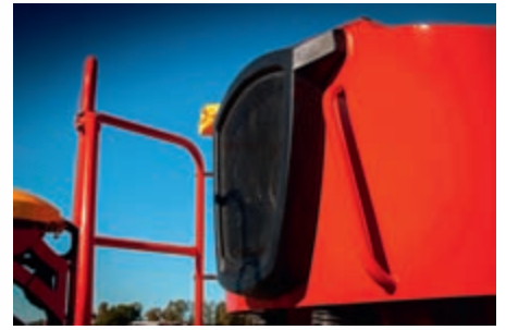
Високе розташування вентилятора, вбудованого у передню частину бункера для насіння, мінімізує проникнення пилу та зменшує рівень шуму
