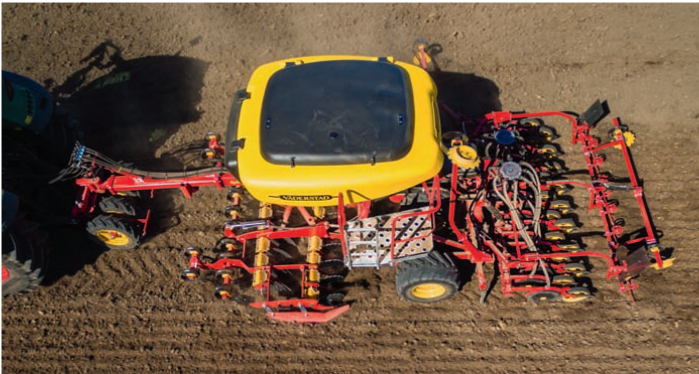
Об'єм пластмасового бункера для насіння становить 2800 літрів. Бокова платформа полегшує доступ при заповненні
