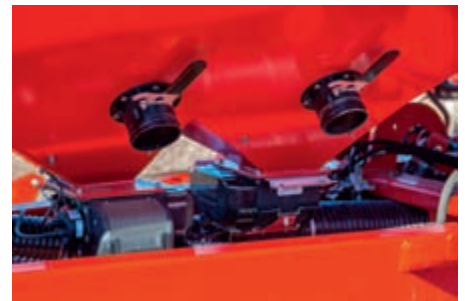
Бункер для насіння має великий отвір для полегшення завантаження та патрубку для вивантаження залишків насіння. Є додаткова бокова платформа
