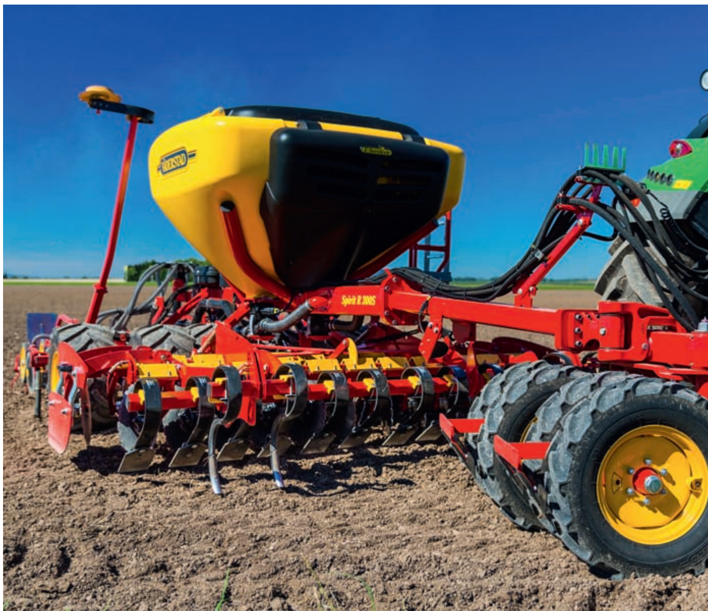
Об'єм пластмасового бункера для насіння становить 2800 літрів. Бокова платформа полегшує доступ при заповненні
