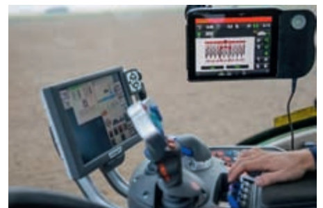
Бездротове управління з використанням системи E-Control або терміналу трактора VT за допомогою ISOBUS. Система дозволяє відключати одну секцію та застосовувати змінні норми висіву з використанням GPS
