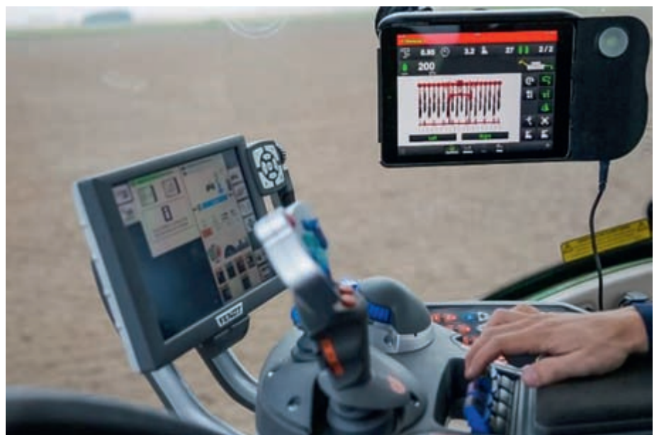
Система E-Control компанії Väderstad забезпечує повний контроль із кабіни трактора. Великий дисплей дозволяє робити чіткий огляд усіх функцій та налаштувань машини
