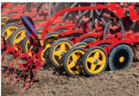
Активне притискне зусилля сошників забезпечує високу точність глибини висіву. Притискне зусилля штригельної борони можна легко регулювати з кабіни трактора
