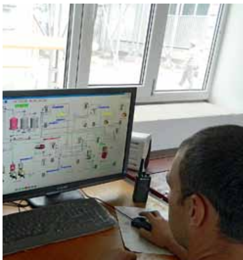
▲ Автоматизована система управління зернокомплексом та її візуалізація, що досить зручна для роботи операторів
