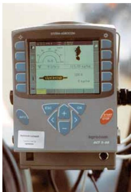
↑ ISOBUS Интегрированный пульт обеспечивает предельную автоматизацию норм внесения удобрений и семян на основе спутниковых данных
