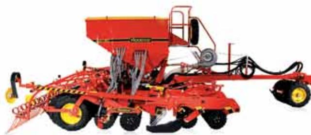
Пневматичні сівалки (тільки посів) RAPID: 6, 8 м
