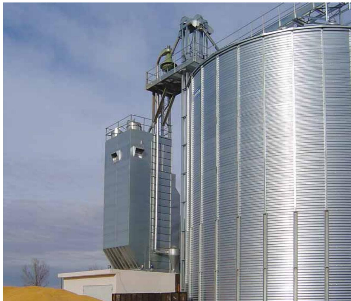
торый проходит через секцию охлаждения, всасываются через радиальный вентилятор и направляются через регулируемую заслонку в камеру горячего воздуха. При этом предварительно прогретая порция воздуха смешивается с основным нагретым агентом сушки, который поступает после горелки. В результате достигается снижение расхода энергии на просушивание потока зерна. Схема движения воздушных потоков сушилки HR изображена на рис. 2.
