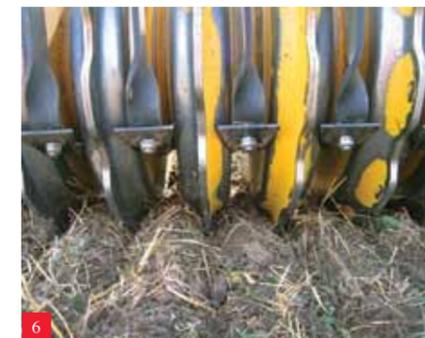
строяемые стрельчатые лапы шириной захвата 300 мм.
