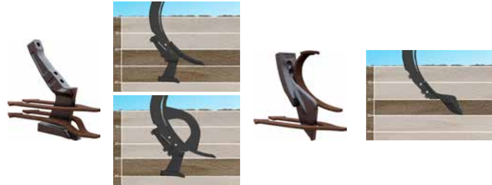
DeepLoosening – Luckring till 40 cm djup med 80 cm mellanrum på sista radens pinnar. Kan kombineras ihop med blandande spetsar (arbetszon 20-40 cm djup) eller brytande spetsar (arbetszon 30-40 cm djup)
