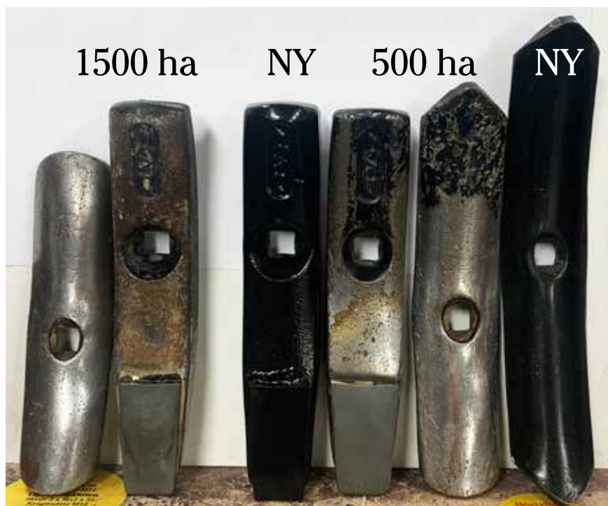
Marathon 25/35 spetsen går det knappt att se något slitage på medan 8 mm HD spetsen sjunger på sista versen efter 1500 ha harvning.
