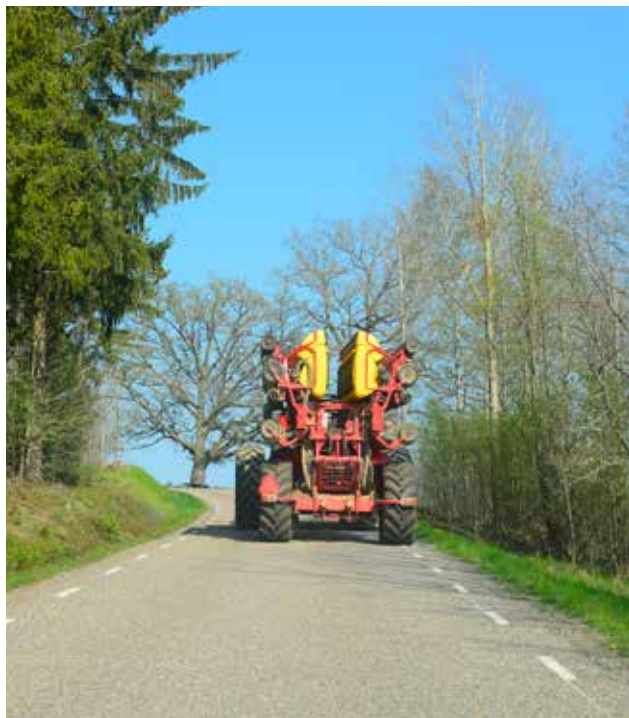
Transportbredden på en Tempo-såmaskin blir som mest 3,4 meter med dubbelhjul trots imponerande arbetsbredder på som mest 12,2 meter på en Tempo L 24.
