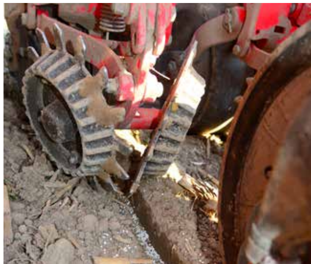
Radrensaren är grejen med Tempo tycker Vicktor. De håller rent från skörderester, sten och jordkokor så att såbilen kan arbeta ostört och placera utsädet exakt.
