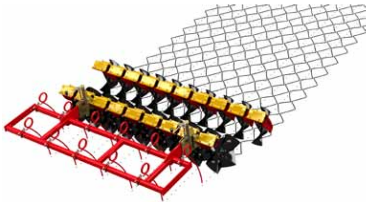
Schemat podcięcia gleby talerzami CrossCutter Disc w agregacie Carrier
