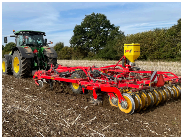
Brian Høj Johansen kalder hans Väderstad TopDown for schweizerkniven. Med muligheden for at justere disk, tænder og pakkervalse hver for sig, kan mange forskellige opgaver løses i en overkørsel.
