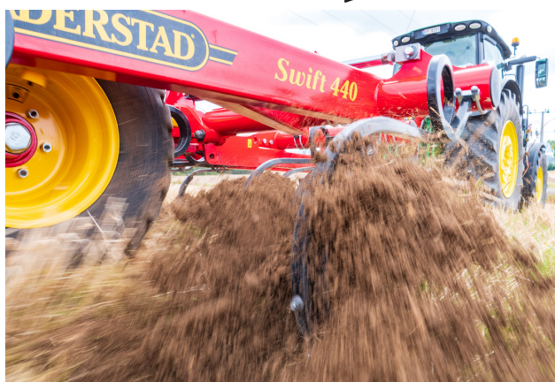
De vibrerende Swift-tænder giver en intensiv opblanding ned til 20 cm arbejdsdybde.
