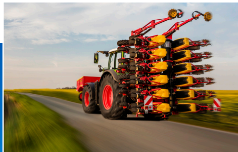
Alle Tempo V-modeller sammenfoldes lodret til en transportbredde på 3 meter.
