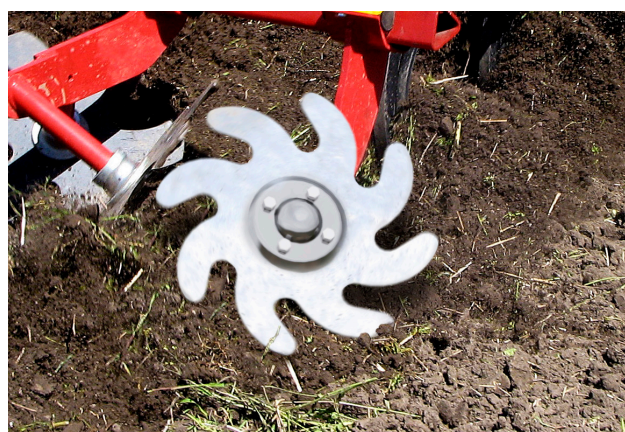
For at kunne tilpasse maskinen efter forskellige jordforhold, kan føreren justere intensiteten på de hydrauliske udjævningsdiske med millimeterpræcision uden at standse.
