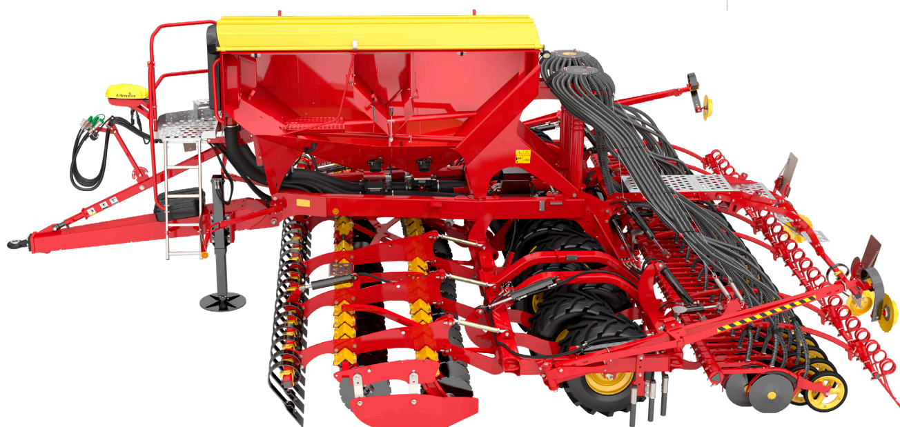
Med en BioDrill kan der sås småfrøede afgrøder samtidig med såsæden
