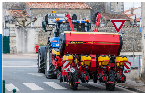
Alle Tempo F-modeller kan sammenfoldes til en transportbredde på 3 meter.
