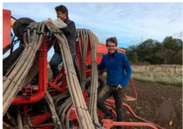
Henrik Hermansson vid fördelaren på sin Rapid A 600C ställer om mellan de olika radavstånden när försöket såddes i september 2018. Mårten Borell i blå tröja gjorde sitt examensarbete om bandsådd och ogräskonkurrens på SLU Alnarp, och håller här ett vakande öga på Henriks radavståndsjustering.
