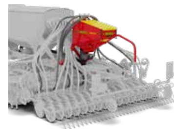
Med en BioDrill kan småfröer sås samtidigt med sädden
