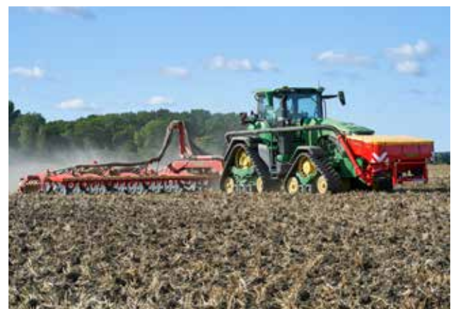
Carrier 1225 XL specialutrustad för sådd av gödning och små fröer. Maskinen går på Sätuna Gods norr om Uppsala och styrfiler används för optimal giva utifrån fältets olika egenskaper.
