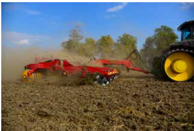
Carrier med CrossCutter Disc agerar nästan som en jordfräs och ansvarar numera för såbruket på hösten till höstvetete och höstraps. Kapaciteten är imponerande, och i 20 km/h avverkar man 8–10 hektar per timma.
