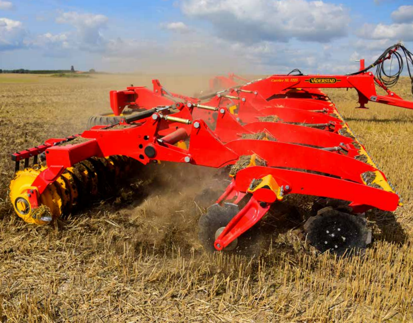
Taltriksvinkeln på Trolleholms Carrier XL 1225 gör att jord och skörderester mixas effektivt.
