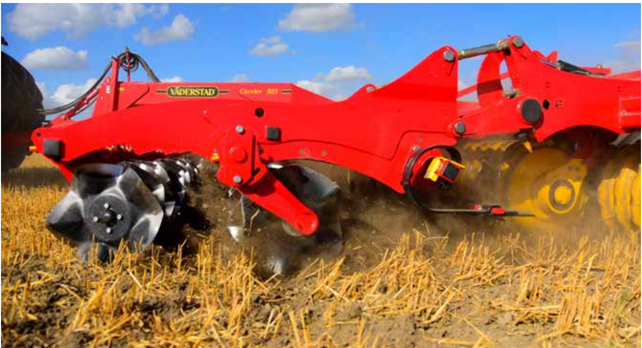
Mot bakgrund av att glyfosat (Roundup) omprövas i EU ändrades försöksplanen i serie R5-1220 hösten 2018. Då testades hur långt effekten räcker av mycket grund bearbetning med CrossCutter Disc i utbyte mot glyfosat – först genom att locka renkavle att gro och sedan i en 2:a överfart genom att döda uppkomna plantor.
