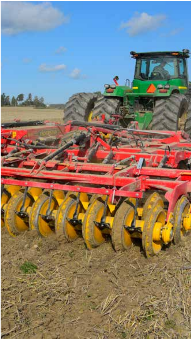
TopDown myllar skörderesterna effektivt och andraårsvetet etableras efter två passager. Den första överfarten myllar halmen och startar nedbrytningsprocessen, så efter den andra överfarten är marken klar för sådd.
