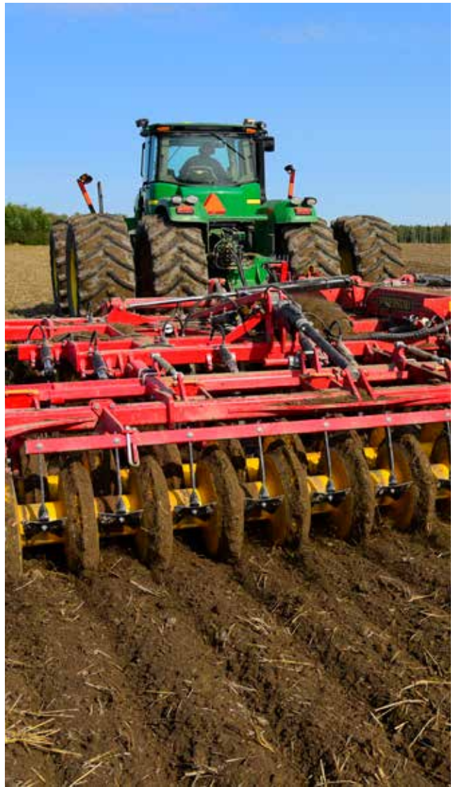
TopDown myllar skörderesterna effektivt och andraårsvetet etableras efter två passager. Den första överfarten myllar halmen och startar nedbrytningsprocessen, så efter den andra överfarten är marken klar för sådd.
