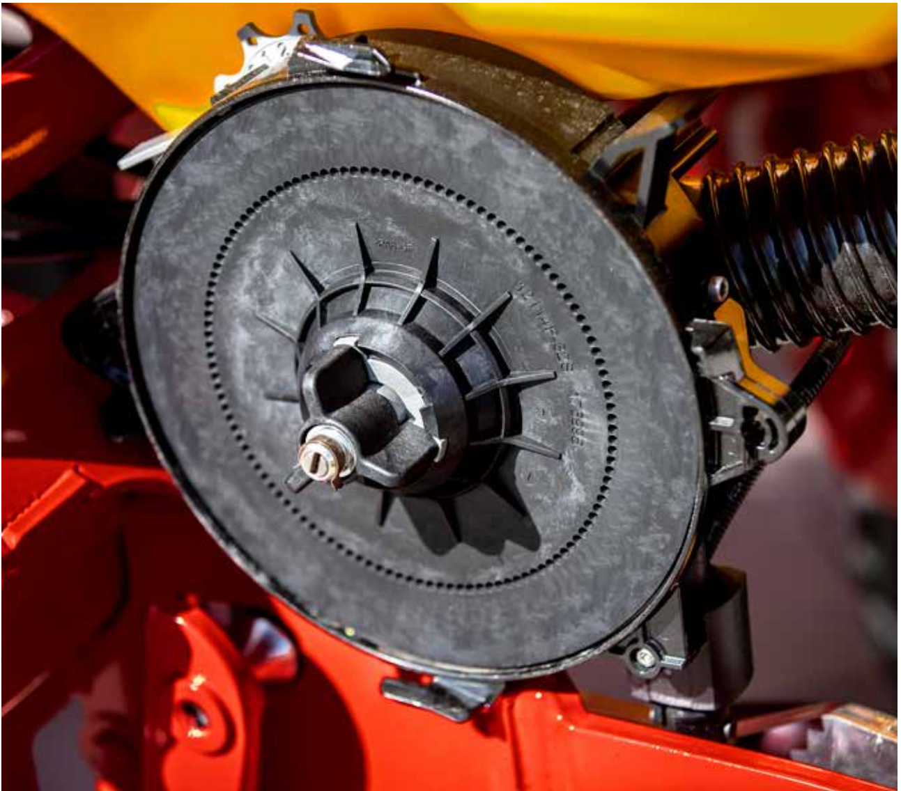
Såskivorna byts enkelt med ett "handgrepp" utan verktyg. Ett stort urval av såskivor finns tillgängliga.
