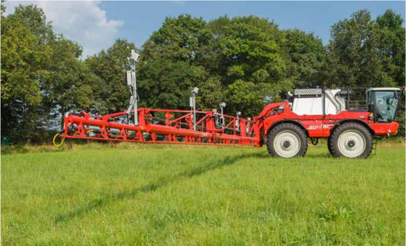
Nya innovationer sker ständigt. Företaget Agrifac lanserade våren 2019 ett koncept där kameror i kombination med artificiell intelligens kan identifiera enskilda ogräs och därefter endast bespruta dessa planter. Foto: Agrifac.
