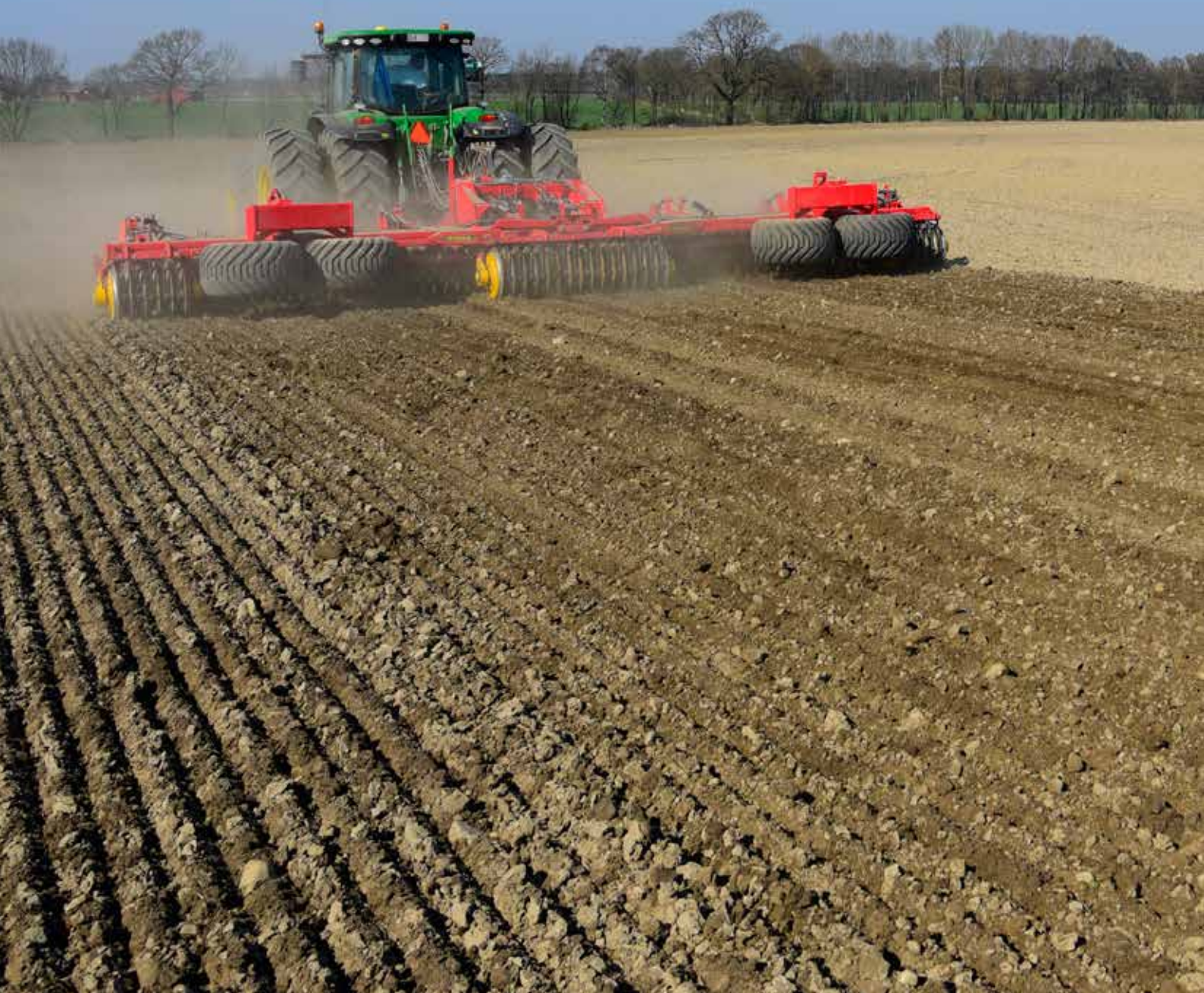
Lönnstorps nya Carrier är tyngre och går stabilare än den gamla maskinen med 16 år på nacken. Inför vårsådden 2019 bearbetades den höstplöjda jorden bara en gång med Carrier 925 utrustad med CrossCutter Disc. Resultatet blev en jämn uppkomst i malkornet.
