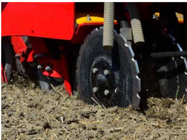
En skivbill lämnar jorden relativt orörd, så etableringen av grödor på våren blir mycket hjälpt av en lätt bearbetning före sådd.
