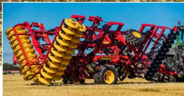
TopDown 400-700 fälls ihop till 3 meters transportbredd.
