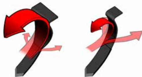
Figur 10. En konisk form på ledskenan tar med mer jord och skörderester i körriktningen och bidrar till bättre fördelningsverkan.
