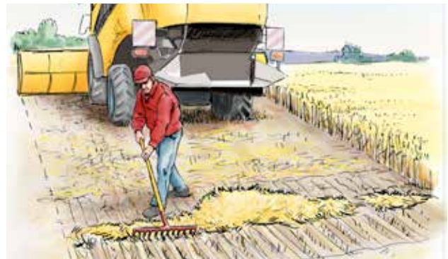
Figur 8. Testa hur väl din tröska fördelar halmen genom att dra ihop 1 meter skörderester utmed tröskans arbetsbredd och bedöm jämnheten.
