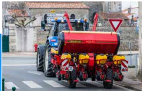
Alla Tempo F-modeller fälls ihop vertikalt till en transportbredd på 3 meter.
