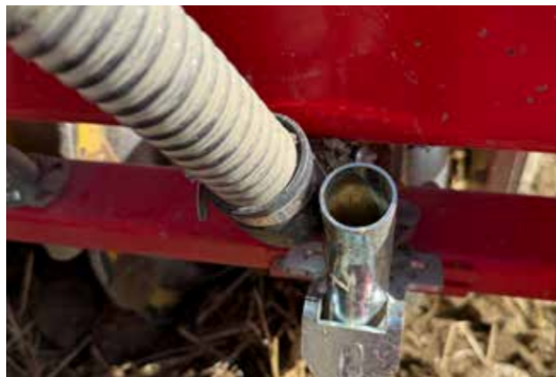
Genom ett rör landar Trolleholms höstrapsutsäde på marken i jordflödet från kultivatorpinnar och ledskenor. Därefter kommer återpackarrullen vars tryck kan varieras från hytten.
