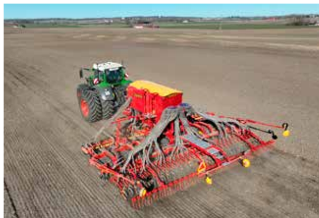
I fältförsöket används en Spirit 600C Nordic som sår på både 12,5 och 25 cm radavstånd i olika strategier.
