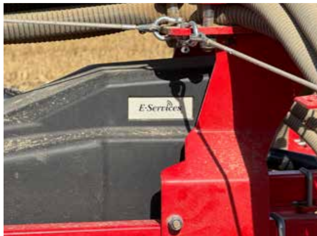
Med E-Services på TopDown kom möjligheten till bl.a. förvalda inställningar vilket underlättar vid snabba skiftavlösningar på kultivatoren när det är bråda tider.
