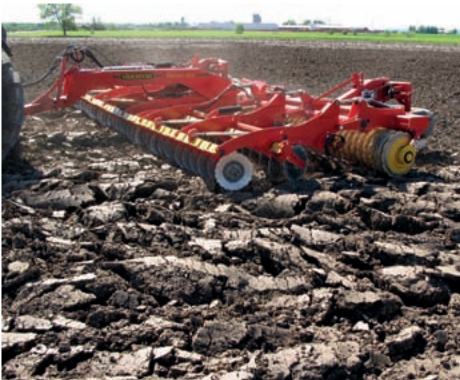
◀ CR-925 із системою Crossboard робить якісну оранку за один прохід
