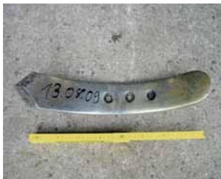
Beim Wechsel nach rund 450 ha hatten die Standardscharspitzen im Schnitt 7,4 cm Länge eingebüßt.
