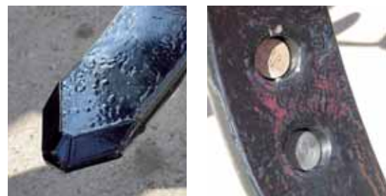
Die Vertiefungen für die Bolzen sind ein wichtiges Detail, damit die Köpfe nicht abgeschliffen werden und abreißen.
