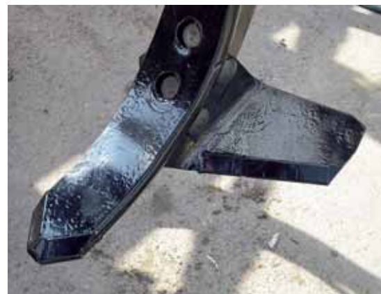
Bei den Marathon-Verschleißteilen sind die aufgelöteten Hartmetallplättchen an den vorderen Schneidkanten gut zu sehen.
