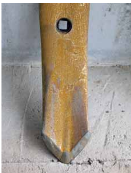
Die Marathon-Spitzen werden voraussichtlich fünf bis sechs Standardsätze überdauern. Rein nach Anschaffungskosten amortisieren sie sich bei dreifacher Standzeit.
