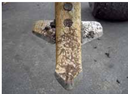
Im Vergleich nach 920 ha zeigen sich deutliche Unterschiede zwischen Standard- (links) und Hartmetallwerkzeugen (rechts). Im Bild links ist die dritte Standardspitze nach 100 ha Einsatzfläche zu sehen.
